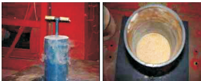
Figura 8 – Ensaio de vibração mais pressão de 10 kPa (K=9)
